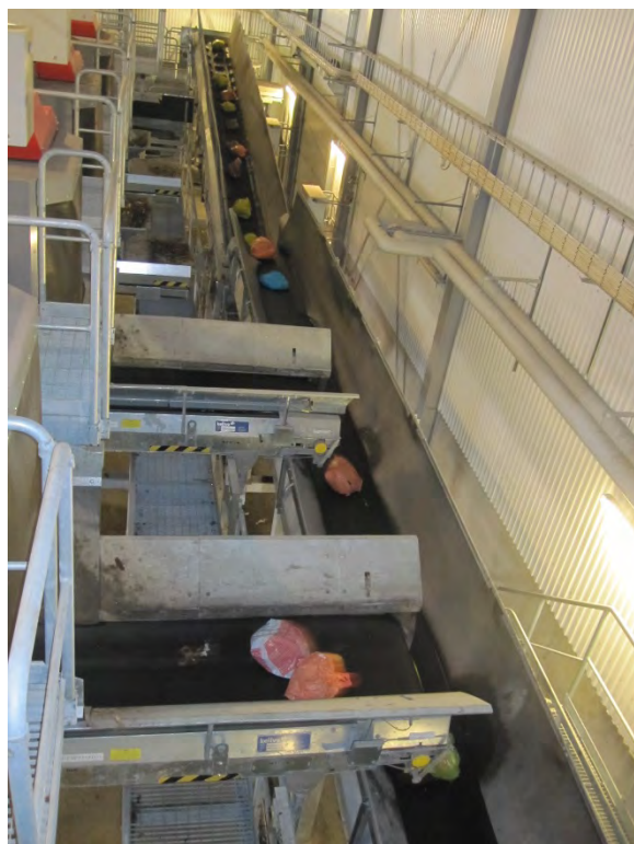
Figur 1 Optisk sortering av de olikfärgade påsarna sker i Eskilstuna. Här sker sortering i sju olika fraktioner.
