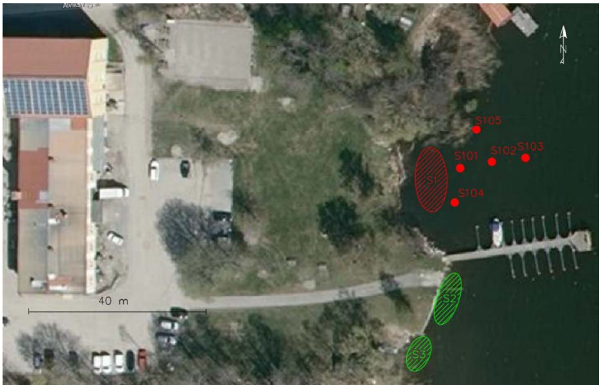
Figur 4. Lokaliseringen av provtagningspunkter för sediment i anslutning till fastigheten Vannesta 1:27. Sedimentprover har tagits i punkterna S101-S105 och som blandprover från områdena S1, S2 och S3. Grönmarkerade sedimentområden/punkter bedöms vara opåverkade eller endast marginellt påverkade av metallföroreningar (= samtliga metallhalter underskrider MPC, effektbaserade holländska riktvärden för sediment). Rödmarkerade sedimentområden/punkter är föroreningspåverkade avseende en eller flera av metallerna kadmium, koppar, kobolt, nickel och kvicksilver (=halter överskridande MPC, effektbaserade holländska riktvärden för sediment).
